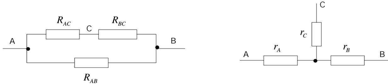
• Entre les bornes A et B, la résistance équivalente vaut d'une part :
