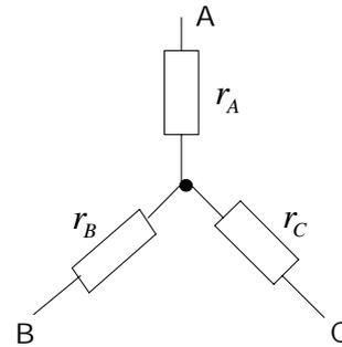
Soit un réseau comportant 3 bornes A,B,C et constitué de 3 résistances montées en « triangle » ; nous allons montrer qu'il existe un réseau équivalent **pour l'extérieur**, constitué de 3 résistances montées en « étoile ».
